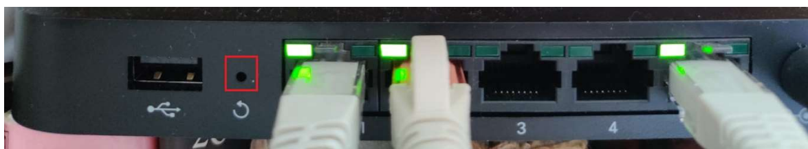
Slika 17: Cisco Meraki Z3 – tipka za reset
