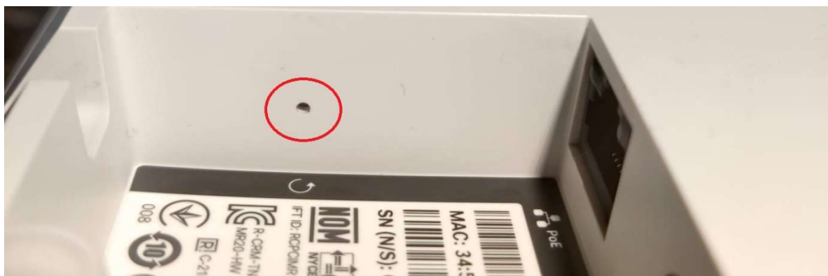
Slika 18: Cisco Meraki MR20 – tipka za reset
